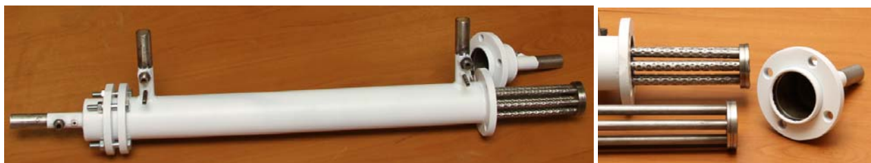
Рис.14. Кожухотрубчатый теплообменный аппарат с различными трубными пучками
