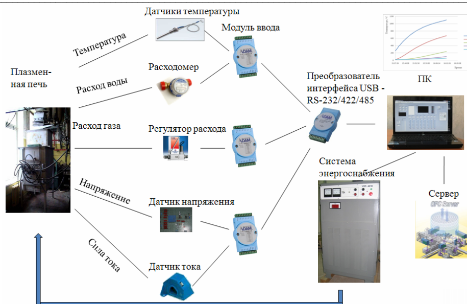
Рис. 2. Схема системы автоматизации и сбора данных
