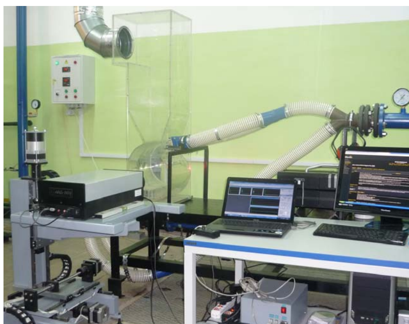
Рис. 3. Измерительный комплекс ЛАД-06 на стенде исследования аэродинамики в модели вихревой топки нового типа
