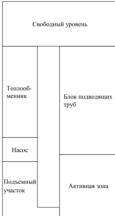
Рис. 1. Принципиальная схема одной петли первого контура ЭКОР
