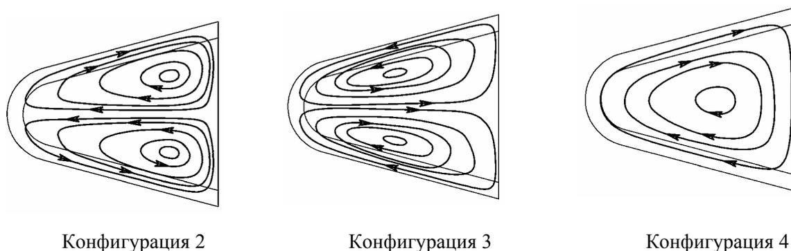
Рис. 16 Структура вторичных течений в каналах со сплошными ребрами
