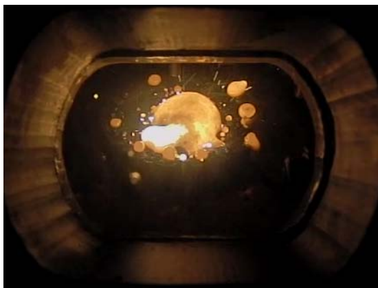
Рис. 18. Фотографии процесса горения частиц железа в кислороде в эксперименте № 8 ( t = 4.013 с, раскаленный расплав в поле зрения пирометра)
