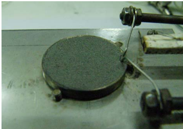
Рис. 5. Взаимное расположение образца частиц железа и элементов системы поджига
