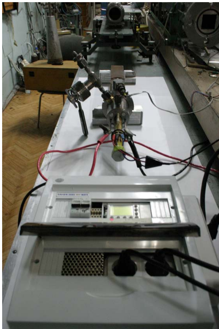
Рис. 4. Вид установки перед размещением образца частиц железа со стороны блока управления, включающего Application Controller ECC-PNAL2-24MR-D; на среднем плане – извлекаемый модуль с подставкой подложек; на заднем плане – разобранный рабочий камера на станине
