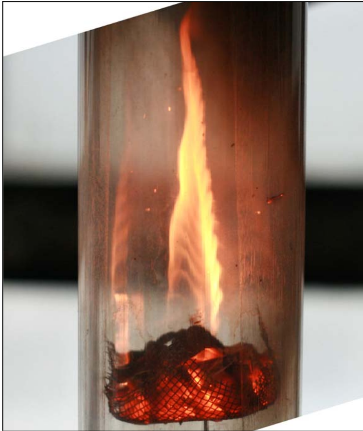
Рис. 6. Флажок диффузионного пламени пеллеты при вибрационном горении древесного угля
