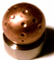
Рис.2. Медная сфера с лунками. 31 лунка,  $d=2,5$  мм,  $h=0,41$  мм,  $h/d=0,164$  мм  $l=5,2$  мм
