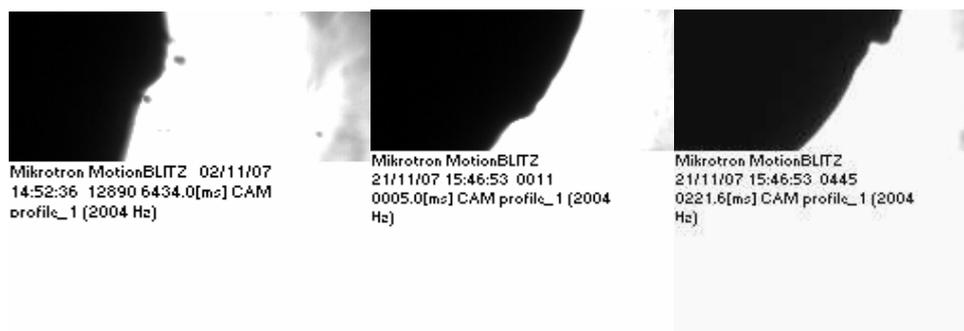
Рис.9. Характерные профили волнового течения пленки пара на поверхности сферы с лунками. ( $f=2004$  Гц, экспозиция 0,02 мс)
