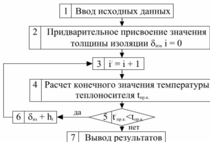
Рис. 2. Блок-схема расчета толщины изоляции при заданных параметрах теплоносителя на выходе из трубопровода
